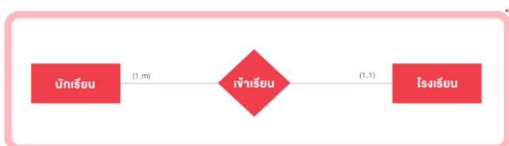
ภาพที่ 2.14 แสดงความสัมพันธ์แบบ Many-to-One Relationship หรือ N : 1
